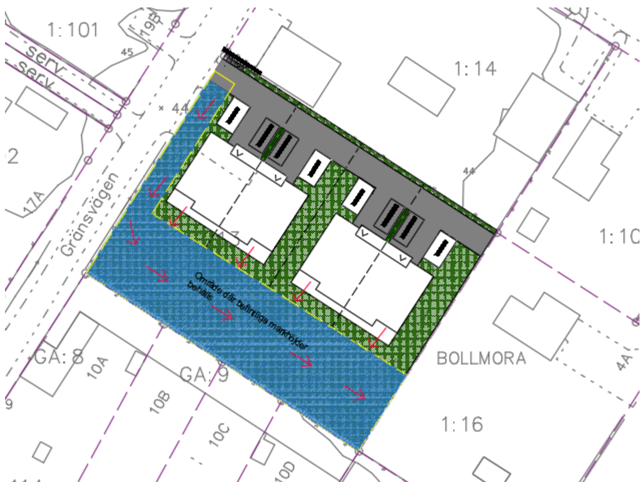
Figur 11. Framtida fastighet med planerad avrinningsväg för skyfall.
