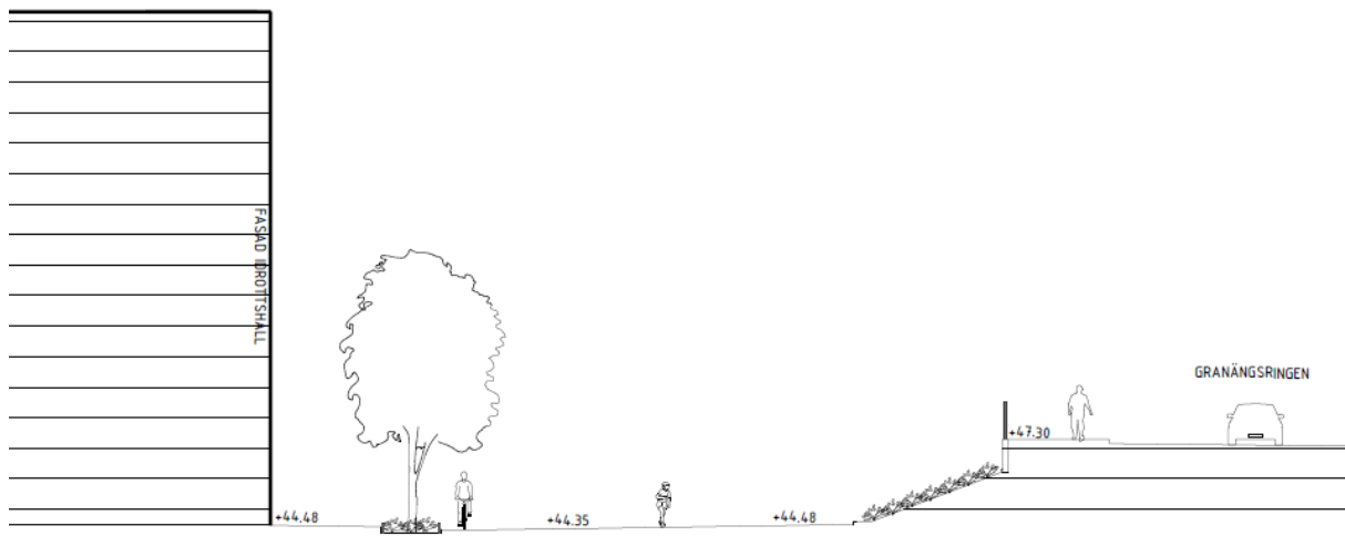
Figur 9. Föreslagen sektion som visar nivåskillnaden mellan platsen öster om idrottsballen och Granängsringen (White arkitekter).
