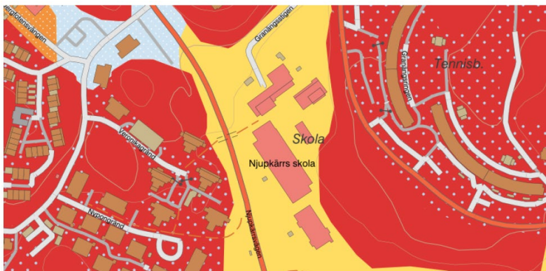
Figur 18. Jordartskarta från SGU:s kartvisare visar att planområdet är omgärdat av urberg (markerat med röd färg enligt kartan).
