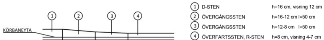
Figur 19 Kantstödsövergång betongkantstöd.
