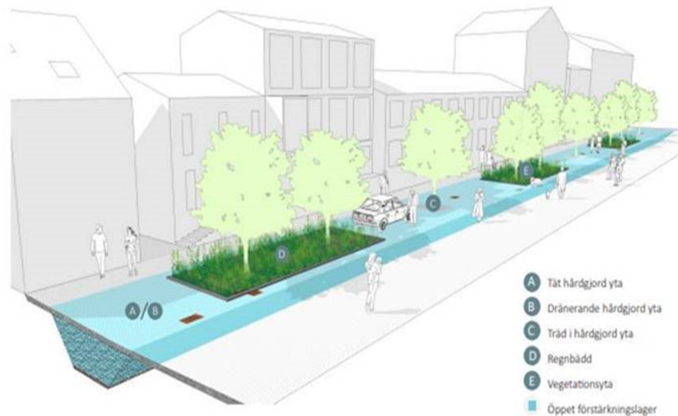
Figur 1 Genomskäring av gata med BGG-system, tagen från handboken Levande stadsrum av Edge
