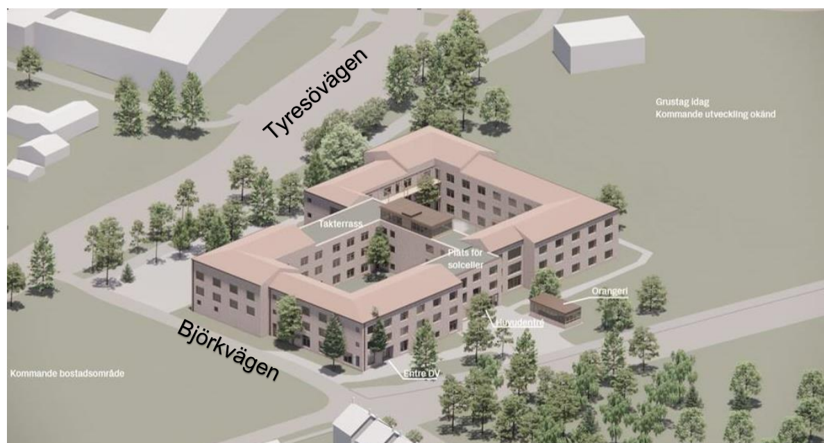
Figur 4-2. Illustration i 3D av planerad byggnad. Saddeltak leder dagvatten både in mot gårdarna och ut mot fastighetsgräns. Terrassytan kan avledas bort från innergårdarna.
