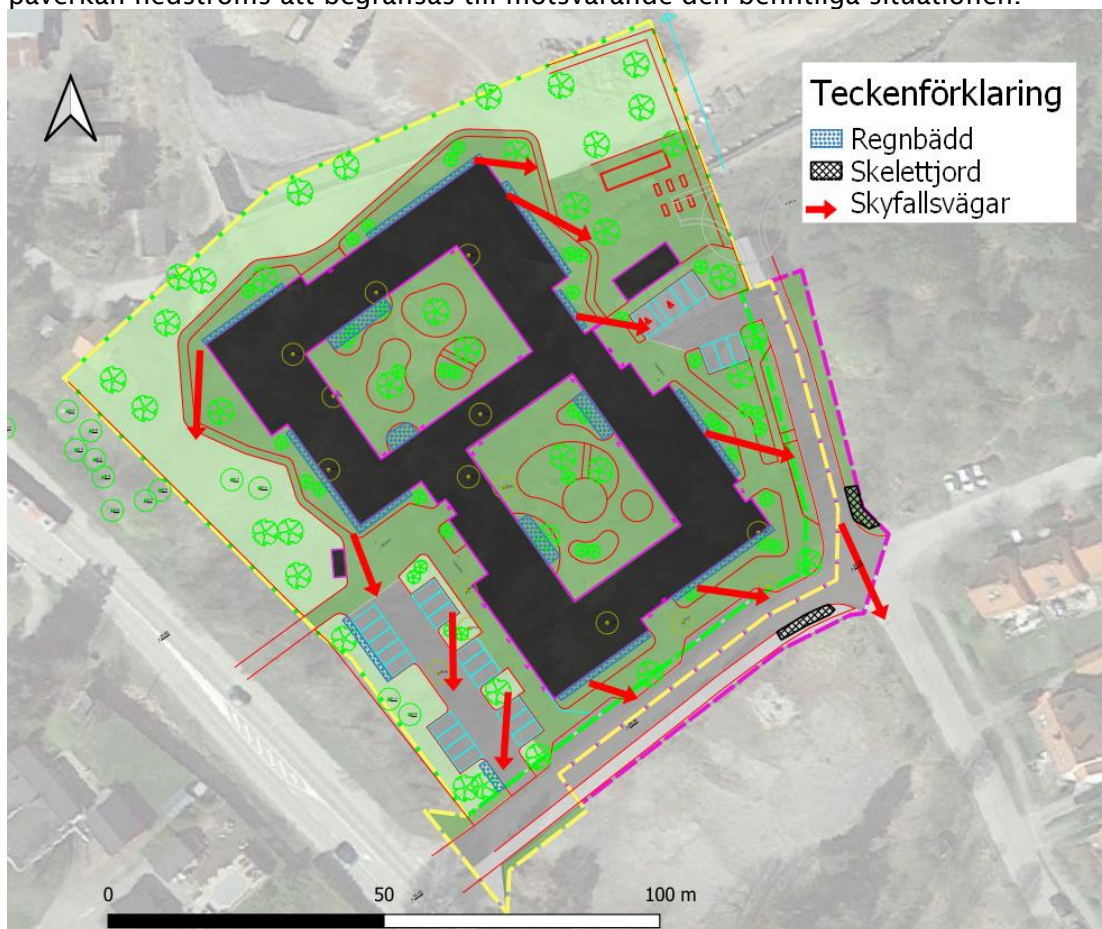
Figur 11-1. Illustration av önskvärda bräddningsvägar för dagvatten vid skyfall.
