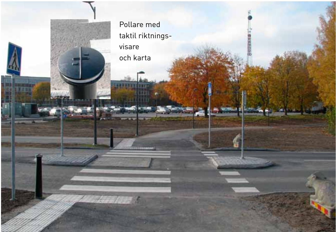
Övergångsställe med pollare och taktila plattor i kontrast mot mörk asfalt
